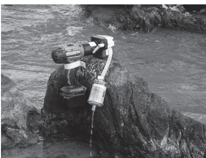
Fig. 6 : Inventaire de poissons par Metabarcoding environnemental. L'ADN détritique se trouvant dans l'eau est collecté à l'aide d'une pompe péristaltique qui envoie l'eau du fleuve dans une capsule de filtration visible au premier plan.
